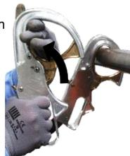
**4** Drücken Sie auf den Drücker des zweiten Karabiners um diesen zu entriegeln. Beide Karabiner sind von der Anschlageneinrichtung gelöst.
