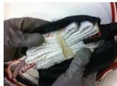
Öffnen Sie die Schutzhülle des Falldämpfers und prüfen Sie, ob die enthaltenen Rissgurte aufgerissen oder durch Abrieb, Schneidwirkung, Chemikalien oder sonstige Einwirkungen beschädigt sind.
