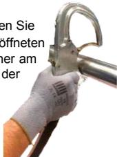
**2** Drücken Sie den Karabiner an der Anschlageneinrichtung in die geschlossene Position.
