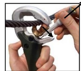
**4** Entfernen Sie das Werkzeug (Art.-Nr. DAS 226) und drücken Sie dabei weiterhin in Öffnungsrichtung auf den Schließzylinder.
