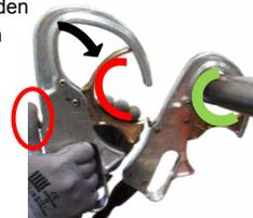
**4** Setzen Sie den zweiten Karabiner auf die gesicherte Anschlageneinrichtung.
