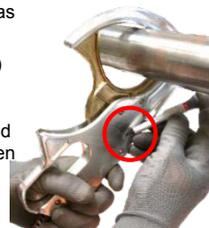
**4** Entfernen Sie das Spezialwerkzeug (Art.-Nr. DAS 226) und drücken Sie dabei weiterhin in Öffnungsrichtung auf den Schließzylinder.
