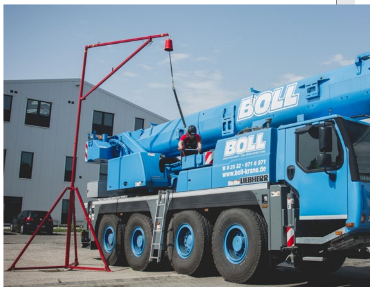
Sicher auf LKW und Baufahrzeugen - der Dreifuß des ABS AirAnchor ist fest am Boden verschraubt.
