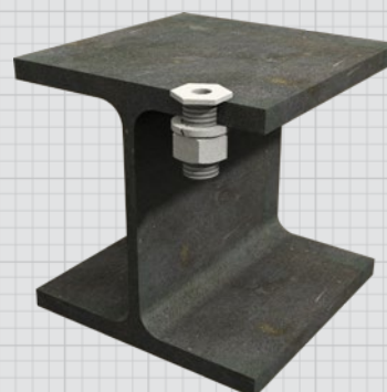
Montage im Stahlträger
