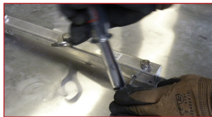
Einfache Montage mit zwei Falzklemmen.
